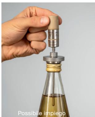
Misura della temperatura in un barattolo/bottiglia con montaggio esterno del data logger: testo 191-T2 + sistema di fissaggio per barattoli e bottiglie
