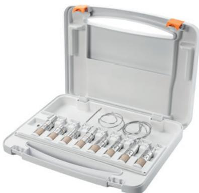
**La valigetta multifunzione** per testo 191 completa il sistema. Robusta, smart e comoda, non serve solo a conservare in tutta sicurezza i data logger, ma anche a configurarli e a leggerli. In ogni valigetta è integrata una stazione di programmazione e lettura. Diventa così possibile configurare e leggere fino a 8 data logger contemporaneamente.
