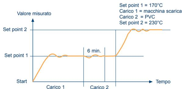
Risultati di un test eseguito su un estrusore equipaggiato con strumenti modello LHS.
