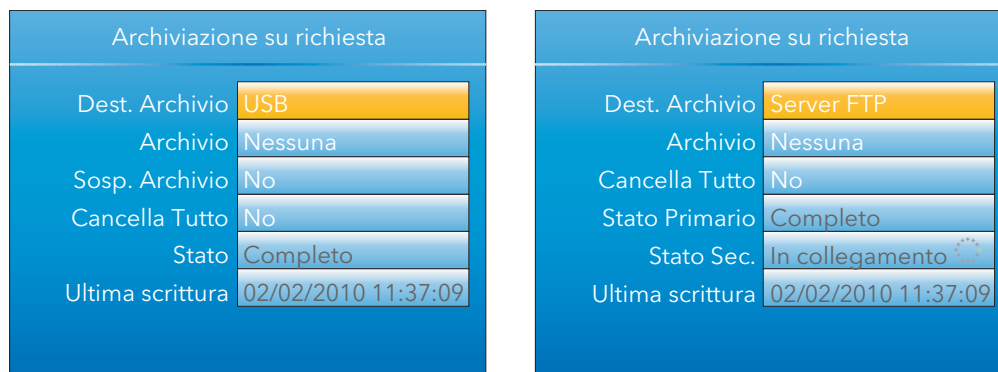
Figura 3.3.8 Menu Archiviazione su richiesta (archiviazione locale a sinistra; archiviazione remota a destra)
