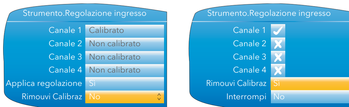
Figura 4.1.8e Rimozione della regolazione del canale
