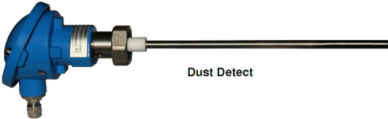
Consente di rilevare in continuo la presenza di materiale particellare all'interno di flussi gassosi espulsi in atmosfera da filtri, abbattitori, depuratori sia per aria che per fumi. Diagnostica l'efficienza degli impianti indicando guasti o anomalie agli elementi filtranti quali: maniche, cartucce, tasche, pannelli, ecc.
